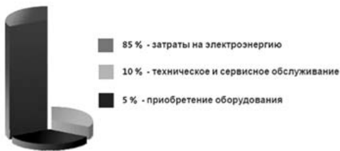
Рис. 1. Распределение статей затрат в течение 10 лет эксплуатации насосного оборудования
