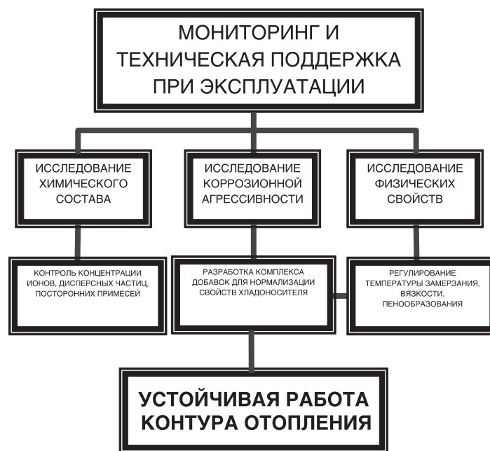
Рис. 4. Последовательность операций при мониторинге и технической поддержке антифриза в процессе эксплуатации
